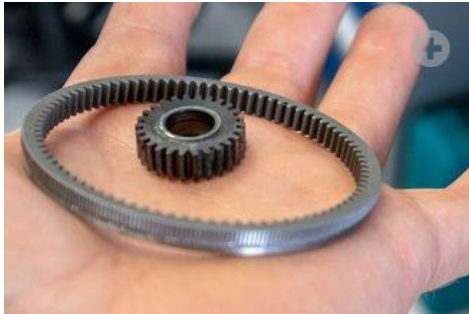
Planetgir: De 14 girene er basert på tre serier med planetgir. Et enkelt og svært solid system basert på en smart løsning (Foto: Odd R. Valmot)
