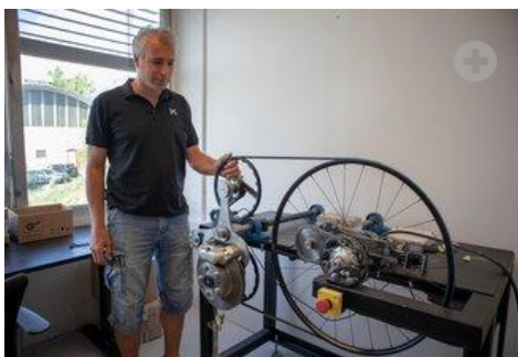
Måleutstyr: Forsknings sjef i CA Tech, Knut Tore Ljøsne med maskinen som er konstruert for å måle virkningsgraden i Kindernay XIV. (Foto: Odd R. Valmot)
